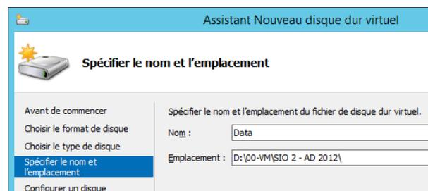
Redémarrez le serveur et finaliser la configuration de ce nouveau disque E: en créant la partition nécessaire et en le formatant en NTFS (New Technology File System) puis créez le répertoire E:\Data.
