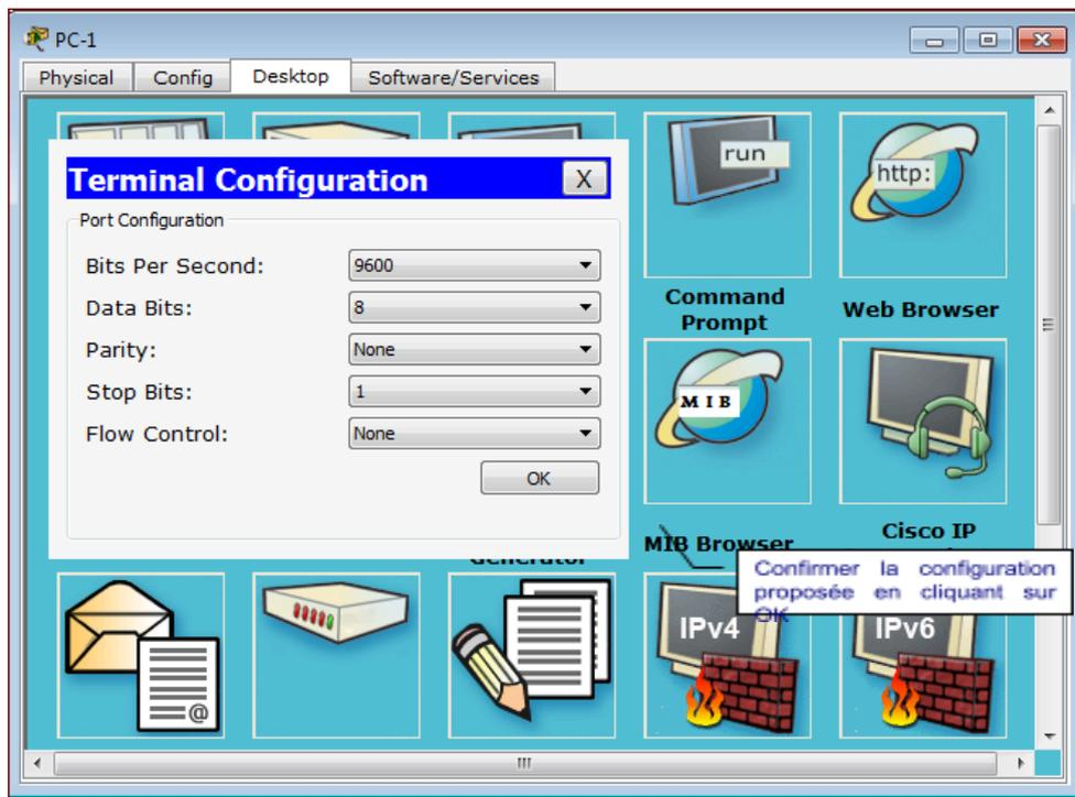
On obtient l'accès au routeur via le terminal pour le configurer :
